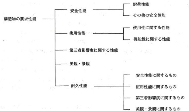
図-12 構造物（部材）の性能の分類<sup>1)</sup>
